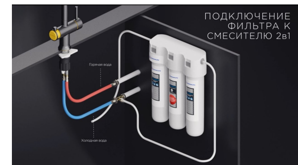
Приклад підключення фільтра для води до змішувача
